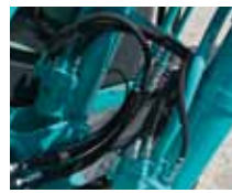
万一のホース破断に備えたブームセイフティ配管
