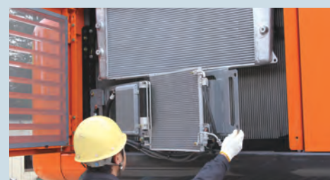
ラジエータの清掃がしやすい開閉式エアコンコンデンサ
