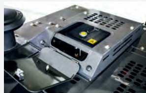
エキスパンションタンク
